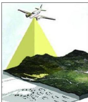
ภาพ 8 การบินถ่ายภาพทางอากาศ เครื่องมือทางโฟโตแกรมเมตรีและแผนที่ภาพถ่าย
