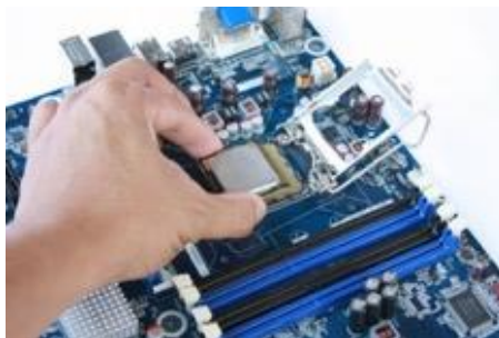
รูปที่ ๓๘ การติดตั้ง CPU
