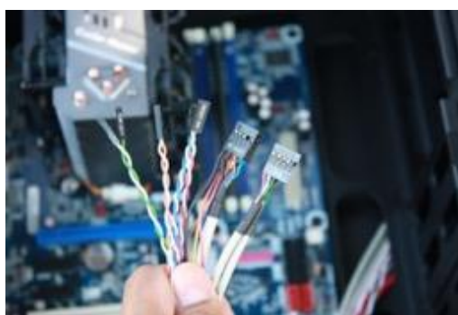
รูปที่ ๔๕ การต่อสายบนเมนบอร์ด
