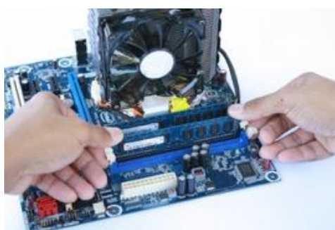
รูปที่ ๔๒ การติดตั้ง RAM
