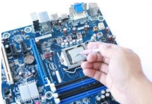
รูปที่ ๓๙ การทาซิลิโคน
