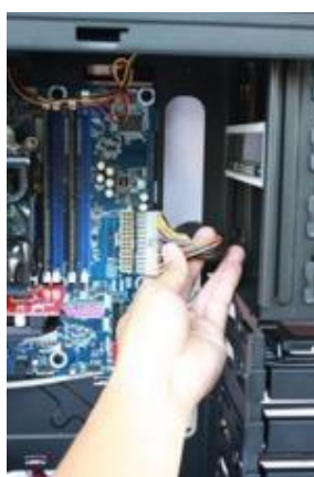
รูปที่ ๕๔ การติดตั้งสาย 24-pins
