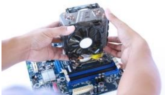
รูปที่ ๔๐ การติดตั้งฮีตซิงก์
