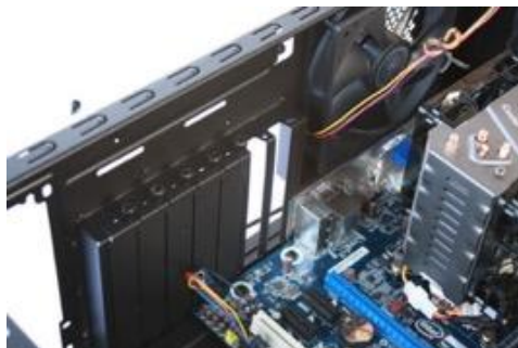
รูปที่ ๔๗ การแกะแผ่นปิดสล็อตด้านหลัง
