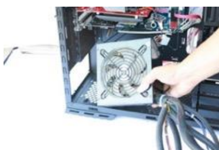
รูปที่ ๕๒ การวางพาวเวอร์ซัพพลาย
