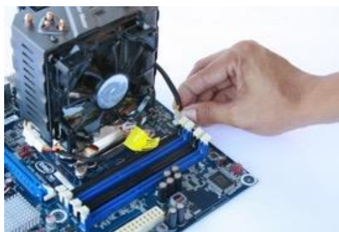
รูปที่ ๔๑ การต่อสายฮีตซิงก์
