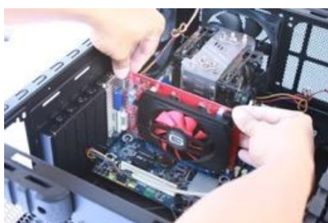
รูปที่ ๔๘ การติดตั้งการ์ดจอ
