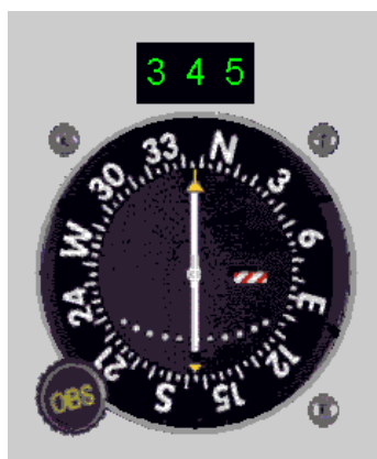
รูปที่ ๓.๒๒ การแสดงผลระบบ VOR ใช้งานไม่ได้
