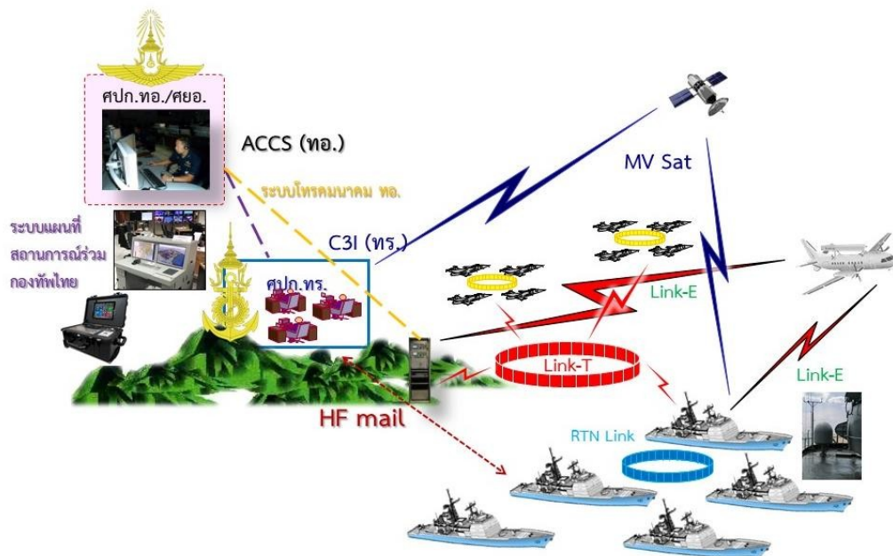
รูปที่ ๔๖ ระบบเชื่อมโยงข้อมูลทางยุทธวิธี กับ บ.ค.๑
